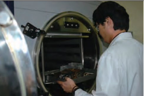
그림 8 동결건조시 유물의 온도측정을 위한 온도 센서 장착
