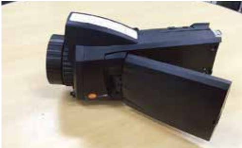
그림 244 적외선 열화상 카메라(Testo 890-2) 및 촬영 장면
