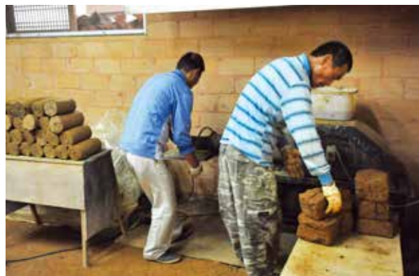
사진 90 토련기를 이용한 태토 반죽
